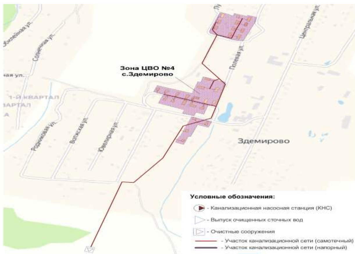
Рис. 1.37. Зона централизованного водоотведения №4 с.Здемирово Подольского сельского поселения
