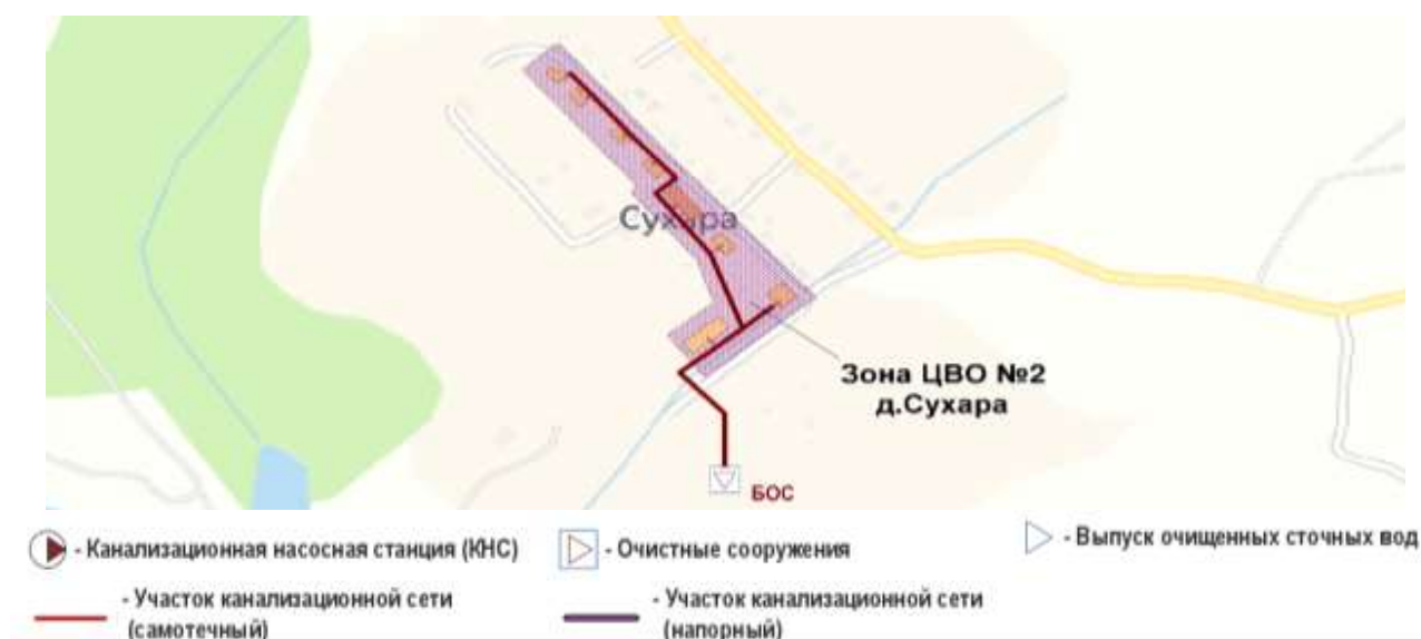
Рис. 1.25. Зона централизованного водоотведения №2 д.Сухара Прискоковского сельского поселения
