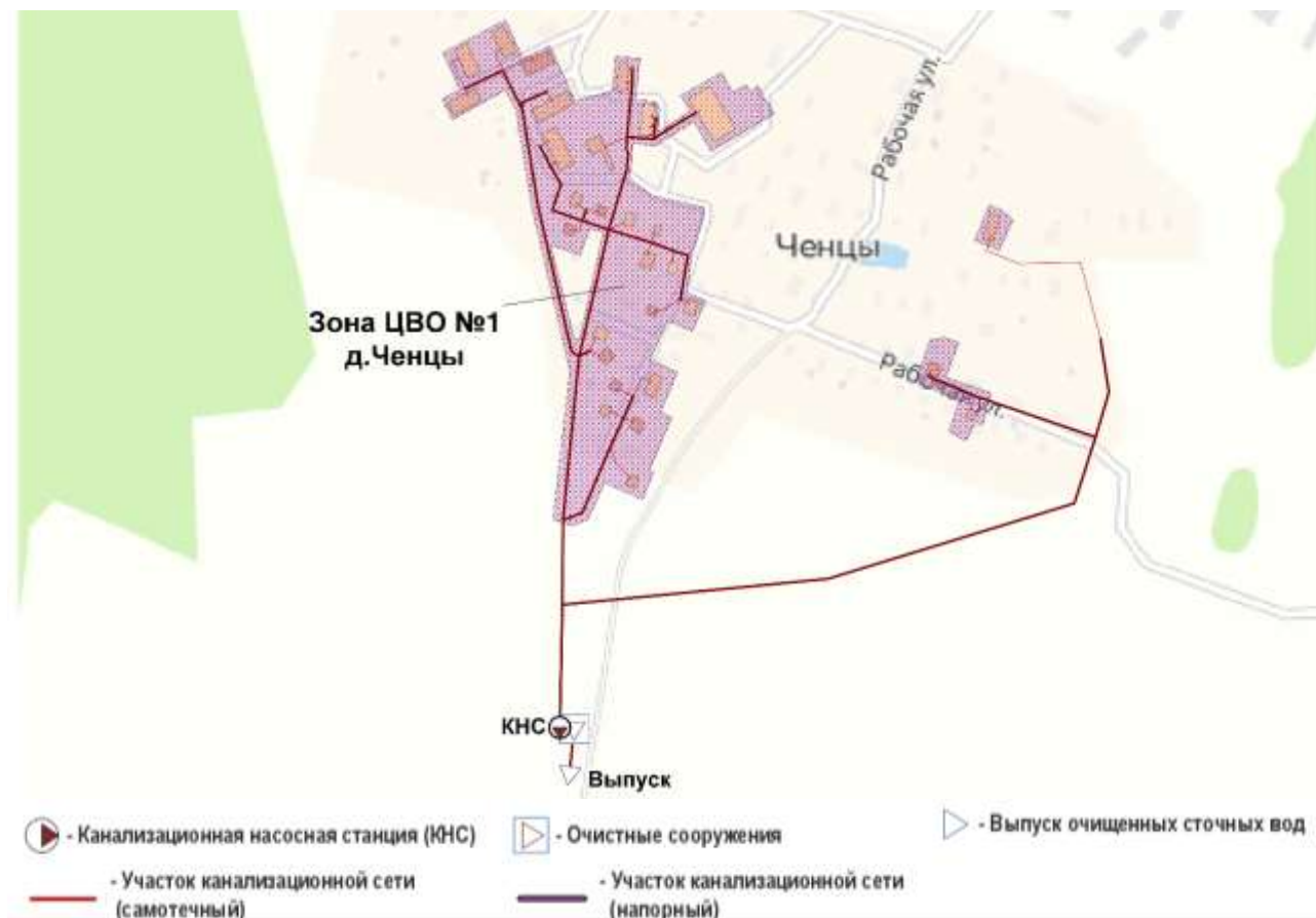
Рис. 1.32. Зона централизованного водоотведения №1 д.Ченцы Чапаевского сельского поселения
