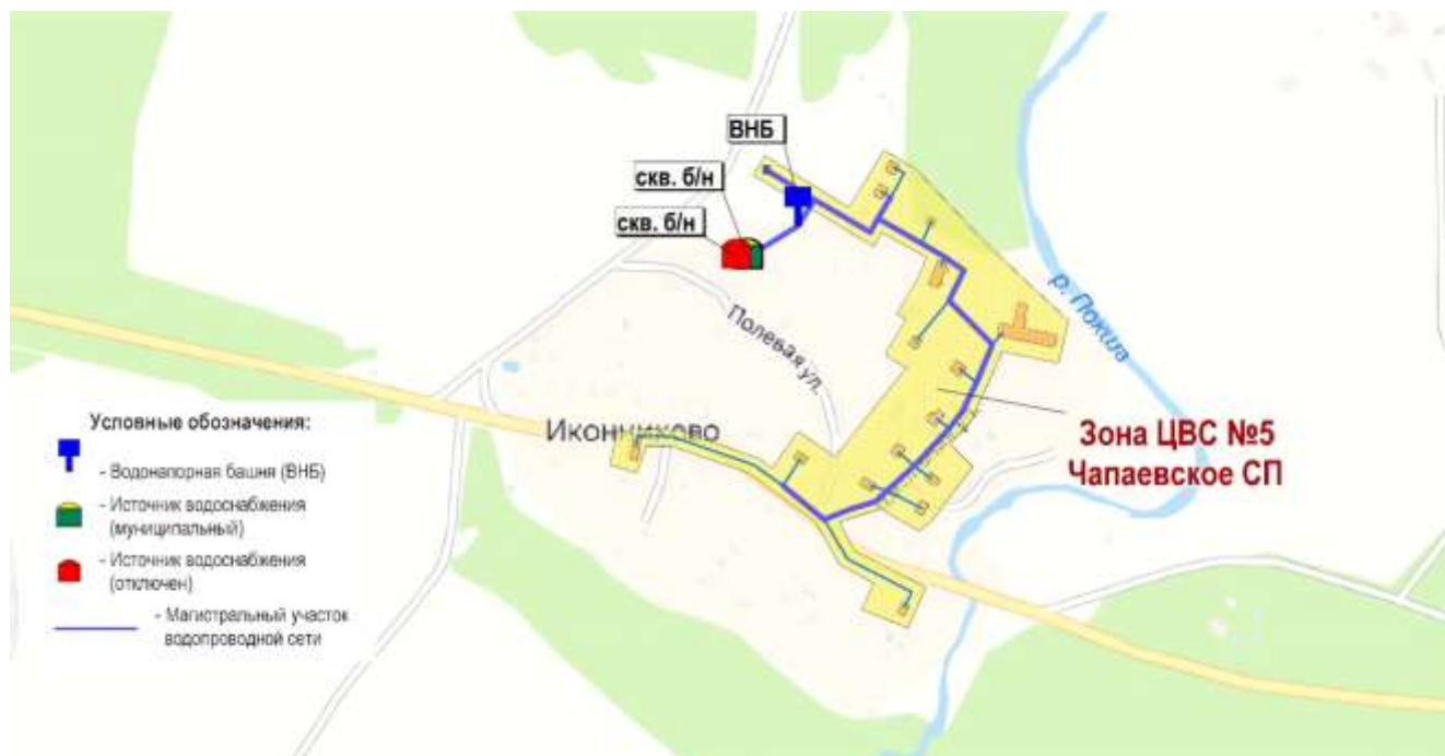
Рис. 1.26. Зона централизованного водоснабжения №5 д.Иконниково Чапаевского сельского поселения
