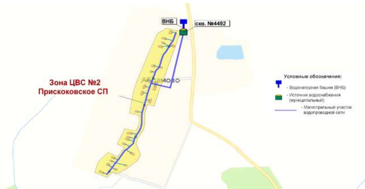
Рис. 1.8. Зона централизованного водоснабжения №2 д.Абрамово Прискоиковского сельского поселения
