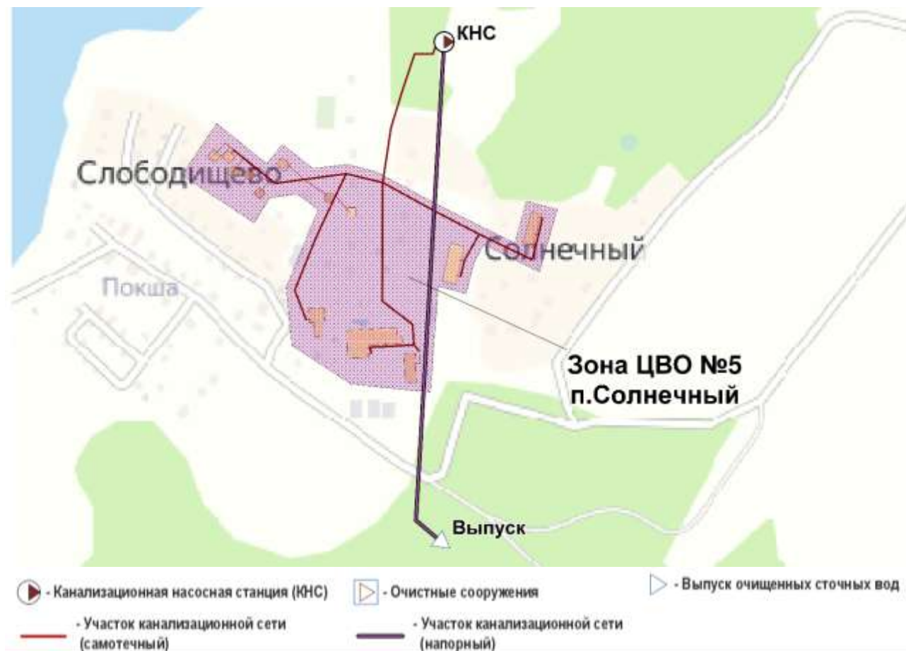
Рис. 1.31. Зона централизованного водоотведения №5 п.Солнечный Боровиковского сельского поселения
