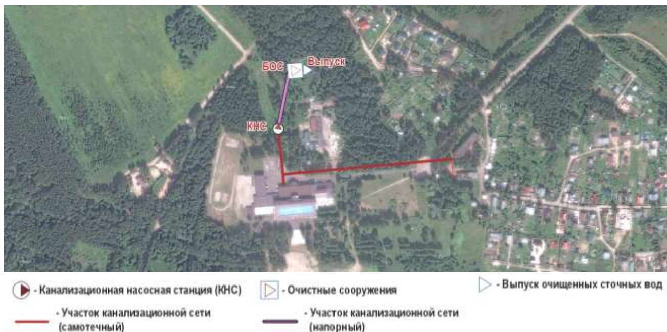
Рис. 1.10. Расположение очистных сооружений п.Молодежный
