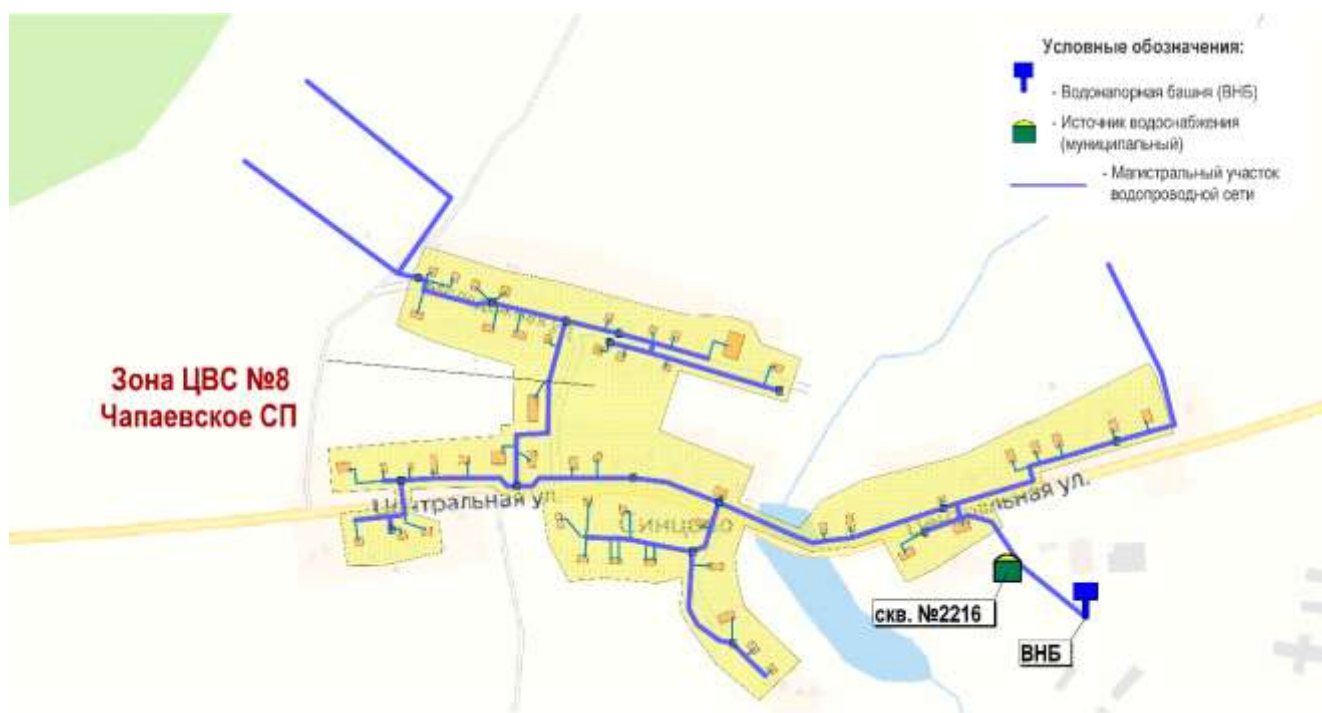
Рис. 1.29. Зона централизованного водоснабжения №8 д.Синцово Чапаевского сельского поселения
