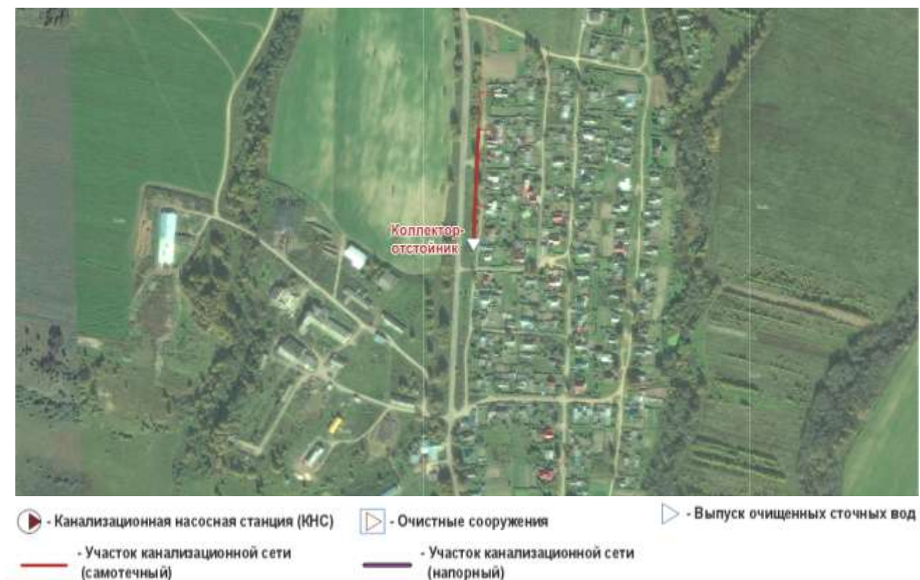
Рис. 1.17. Расположение коллекторов-отстойников в северной части с.Подольское
