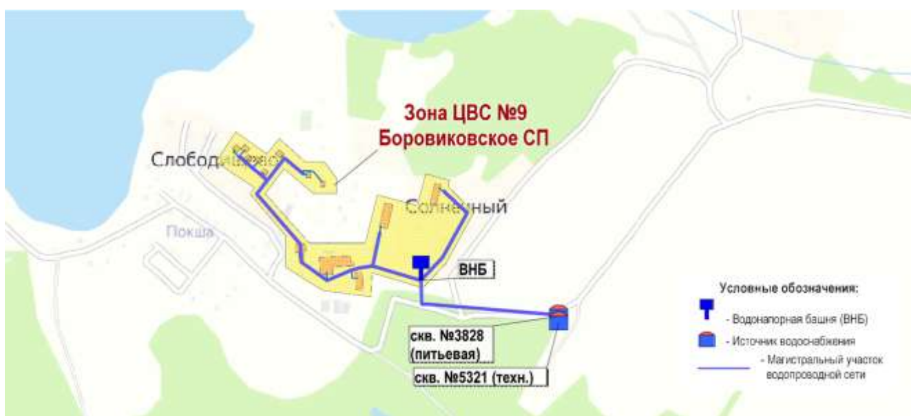
Рис. 1.22. Зона централизованного водоснабжения №9 п.Солнечный Боровиковского сельского поселения
