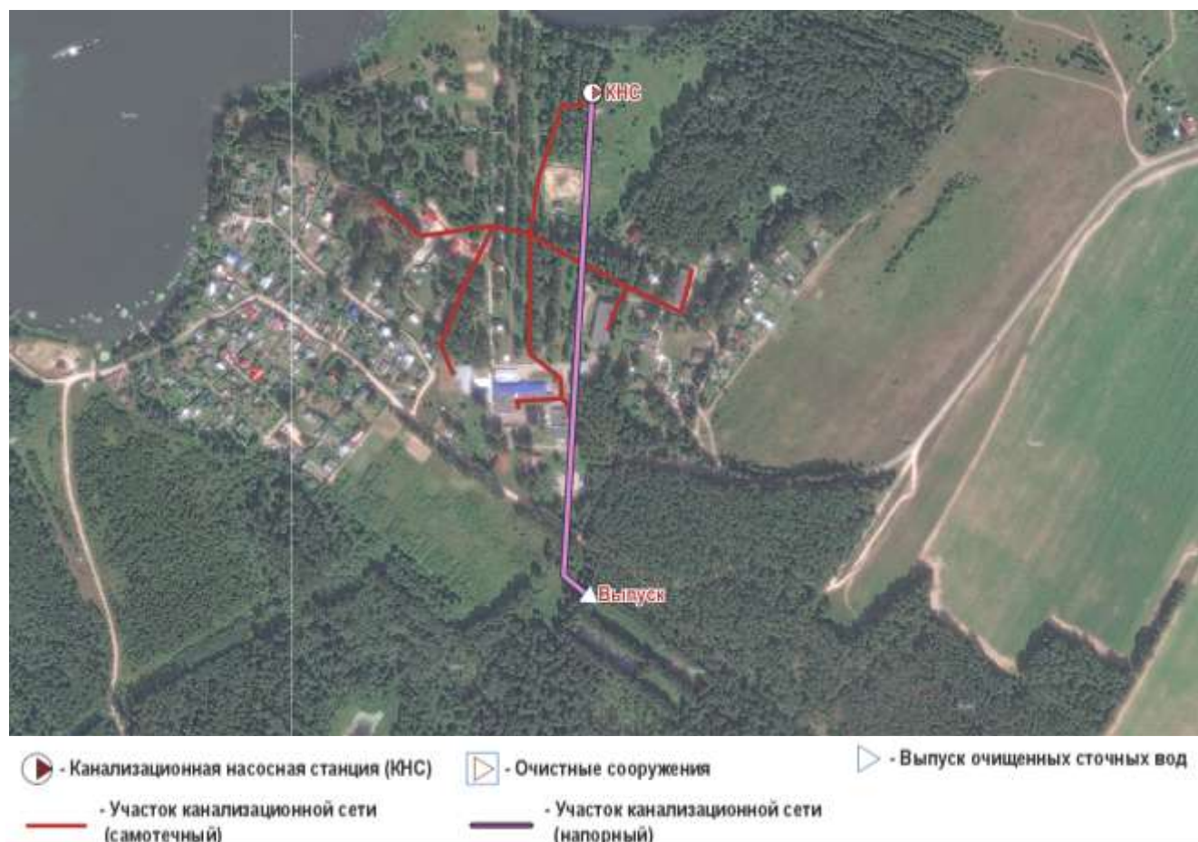
Рис. 1.12. Расположение очистных сооружений п.Солнечный
