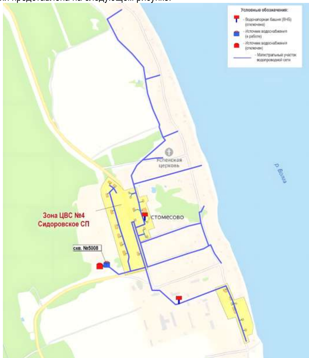
Рис. 1.33. Зона централизованного водоснабжения №4 с.Густомесово Сидоровского сельского поселения
