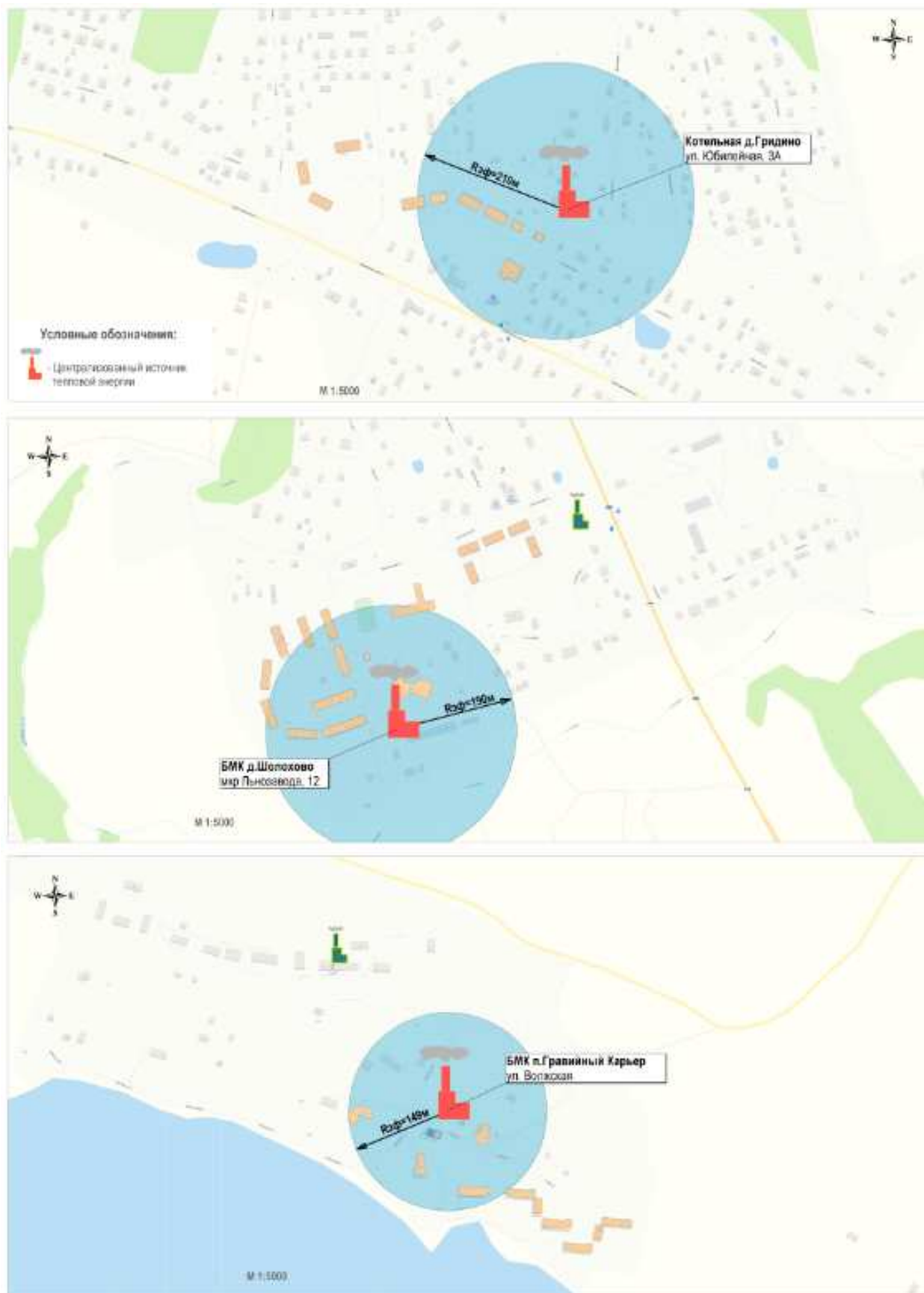
Рис. 2.3. Схема существующих радиусов эффективного теплоснабжения от централизованных источников тепловой энергии Прискоковского, Шолоховского и Гридинского сельских поселений Красносельского муниципального района Костромской области.
